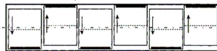
Рисунок 4 – Размещение в полувагоне с внутренней длиной кузова 12700 мм разнотипных контейнеров; количество контейнеров УУК-3, УУК-3(5) – четное
