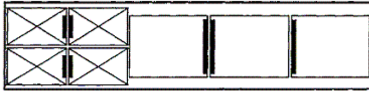
Рисунок 6 – Размещение разнотипных контейнеров в контейнеровозах без обшивки стен, с торцевым ограждением в виде скоб или балок, закрепленных снаружи угловых стоек
